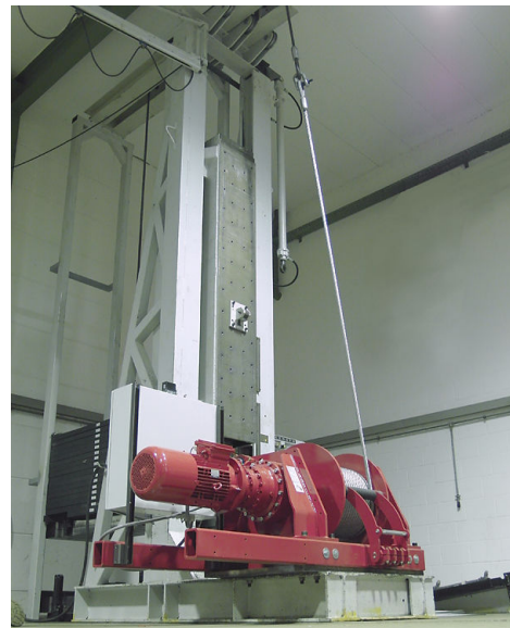
Figure 13 – Câble tendu par un treuil
